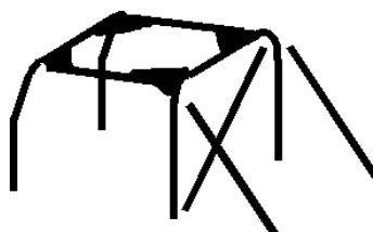
Principe 2 avec les goussets dans les angles
